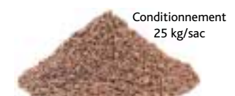
CHAMOTTE RECONSTITUÉE Granulométrie 0 - 12 mm Préparation de béton réfractaire (mélange 2/3 chamotte + 1/3 ciment fondu) pour la construction de linteaux ou de chapes réfractaires.
