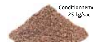
CHAMOTTE N° 2 Granulométrie 4 - 8 mm Utilisée avec la chamotte n° 1 et du ciment fondu. Elle sert à la réalisation de petits linteaux de 8 cm maximum ou pour combler les petites irrégularités des parois en contact avec le feu.
